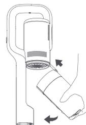
→ Si consiglia di sostituire il filtro ogni 3 mesi per garantire la massima efficienza. Utilizzare solo i filtri specificati dal produttore.
