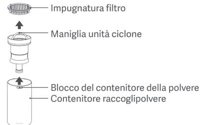
3. Svotare il contenitore raccogli polvere e pulire il filtro e il ciclone con la spazzola per la pulizia. Sciacquarli con acqua corrente. Lasciar asciugare completamente all'aria per 24 ore prima di rimontarli.
